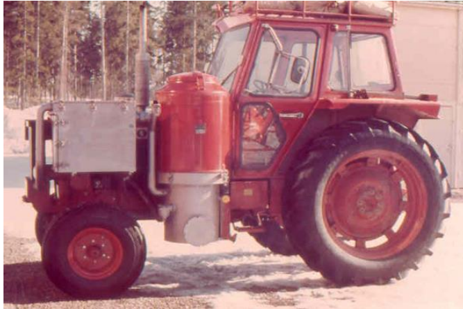
Рис. 1. Газогенераторний трактор фірми Volvo, який працює на pelletованих рослинних відходах
