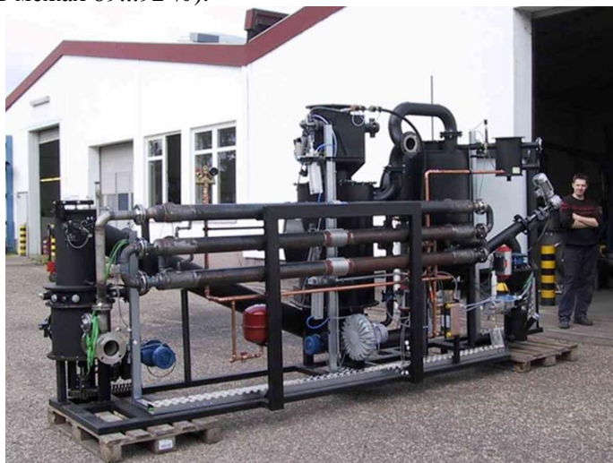
Рис. 5. Газогенераторна установка фірми Spanner RE GmbH (виробництво Німеччини) силовою потужністю 100 кВт, яка працює на деревних відходах вологістю до 30 %
