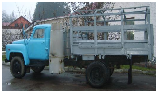
Рис. 6. Автомобіль ГАЗ-53А з газогенераторною установкою
