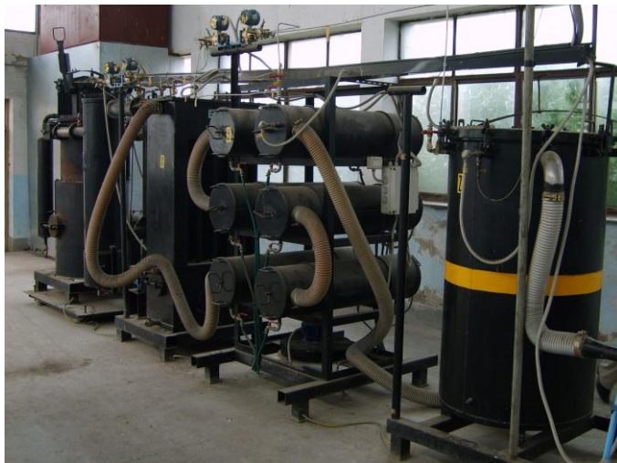
Рис. 2. Газогенераторна установка ENEA (виробництво Італії) силовою потужністю 80 кВт, яка працює на деревних відходах вологістю 25...30 %
