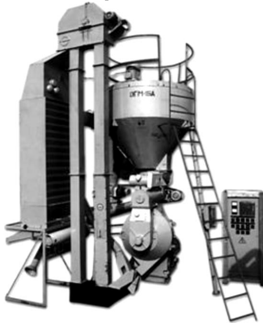
Рис. 4. Зовнішній вигляд вузла гранулювання на базі гранулятора ОГМ-1,5
