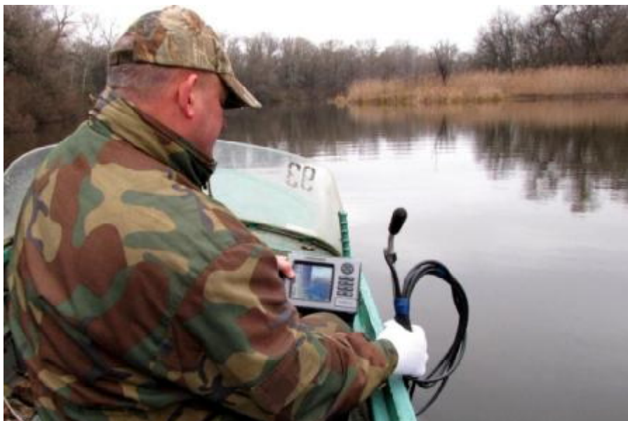
Рис. 2 Виявлення зимувальних ям на озерах Головківське та Качине за допомогою гідросонара
