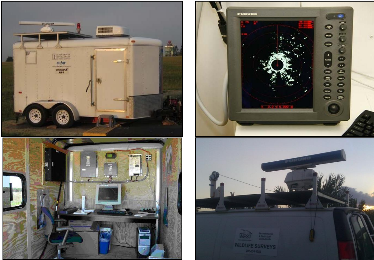
Рис. 1. Варіанти монтажу мобільного радарного комплексу, зовнішній вигляд монітору та робоче місце оператора
