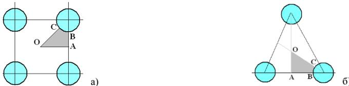
Рис. 1. Расположение рабочих каналов в активной зоне реактора: а) – коридорное; б) – шахматное
