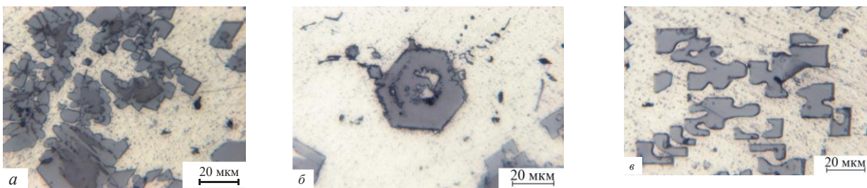
Рис. 4. Структура центральної частини виливки: центр зони (а), мікроструктура первинних кристалів (б), крайова частина зони (в)
