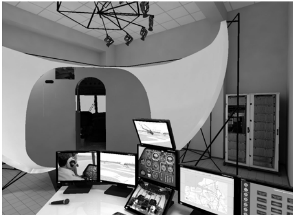
Рис. 4. Комплексний тренажер вертольоту Ми-8МТ виробництва НВО «Авіа» (спереду на рисунку показане робоче місце інструктора)
