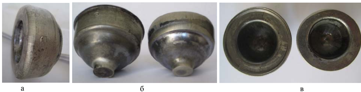
Рис. 5. Экспериментальные поковки: а – после первого перехода штамповки из исходной заготовки; б, в (слева) – за два перехода штамповки; в (справа) – за один переход из исходной заготовки
