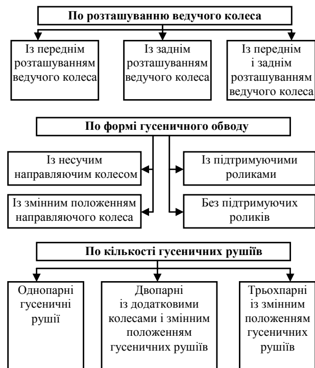
Рис. 1. Класифікація гусеничних рушіїв за конструктивним виконанням
