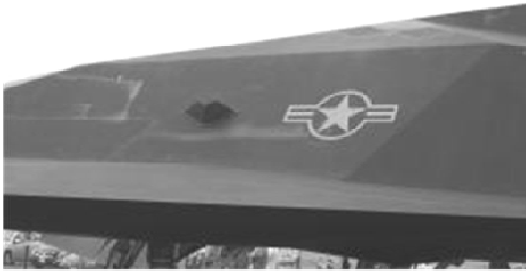
Рис. 1. Отражатель для повышения ЭПР F-117
