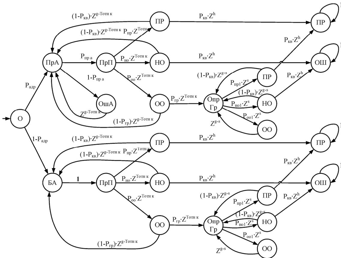
Рис. 1. Граф процесса обмена данными в системах с ОС и адресным обнаружением ошибок
