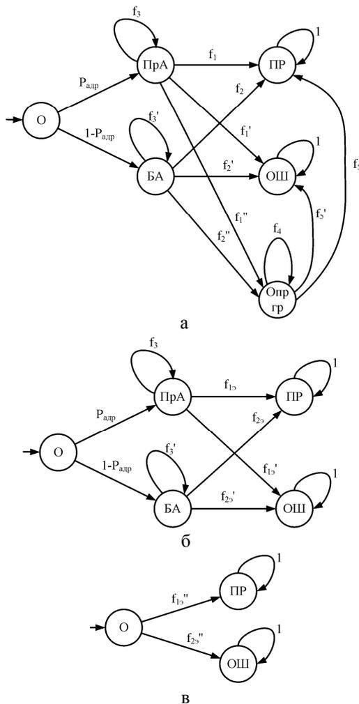
Рис. 2. Промежуточный (а, б) и преобразованный (в) вероятностно-временные графы
