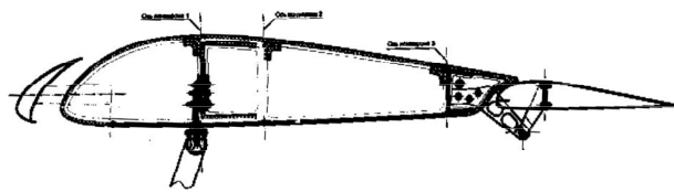
Рис. 10 Самолет ХІАТ-650. Типове сечення крила з механізацією
