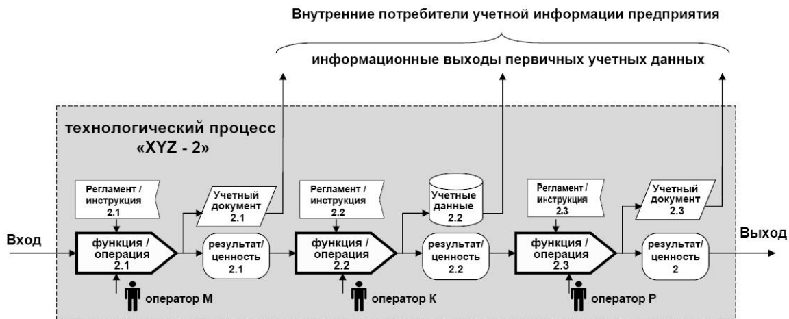
Рис. 5. Базовая структура графического описания потоковых моделей (диаграмм) технологических процессов
