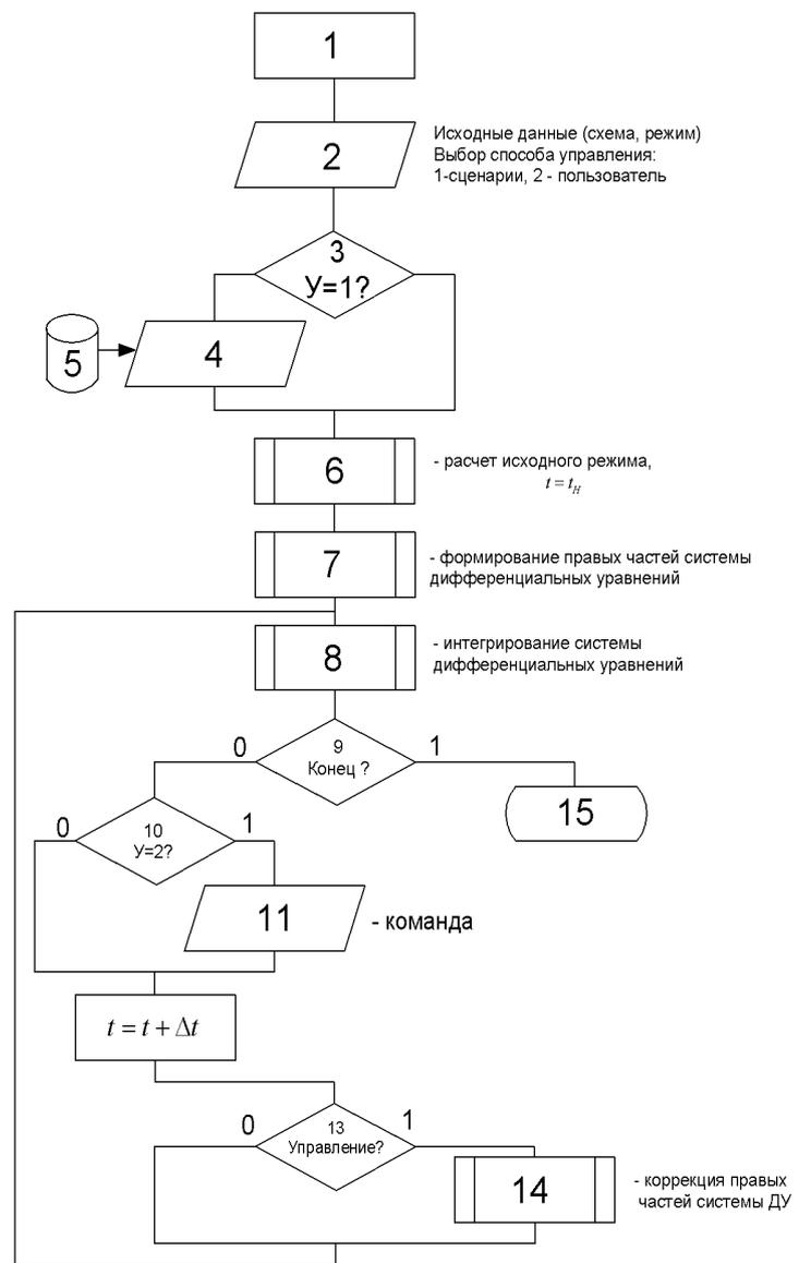
Рис. 1. Алгоритм программы имитационного моделирования
