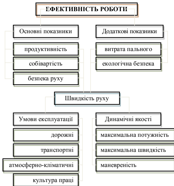
Рис. 1. Зв'язок ефективності роботи АТ з умовами експлуатації
