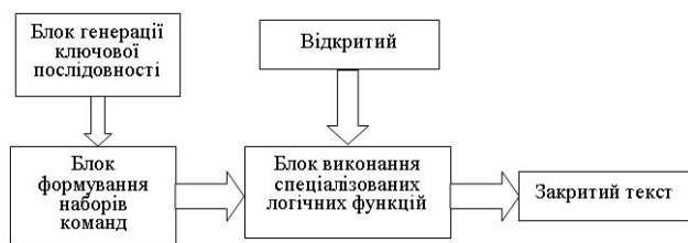
Рис. 1. Типова структура процесу криптографічного захисту інформації на основі логічних функцій
