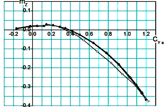
Рис. 10. Залежності m(C_y) (V1 – оцінка впливу деформації крила швидкісним напором)
