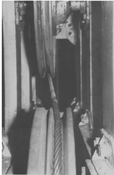
Рис. 2. Кут девіації та штопор в канаті з пружним сердечником при випробуванні на пробіжній машині
