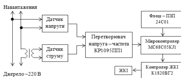
Рис. 2. Структурна схема найпростішого лічильника електроенергії
