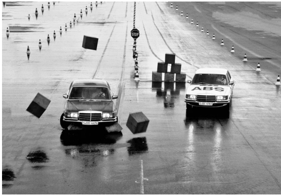
Рис. 2. Поведение автомобилей без и с установленной АБС
