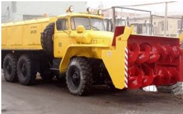
Шнекороторный снегоочиститель ДЭ-226 на базе Урал-4320-41
