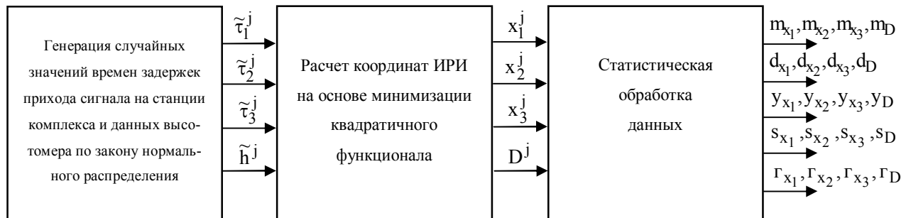
Рис. 2. Функциональная схема статистического моделирования вычисления координат ИРИ методом Монте-Карло
