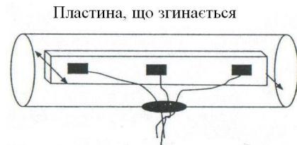
Рис. 4. Гнучка пластина сенсору потоку
