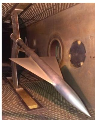
Рис. 1. Модель на хвостовой державке
