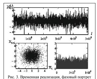
и частотный спектр сигнала на входе приемника
