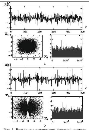
Рис. 1. Временная реализация, фазовый портрет и спектр процесса: a – при  $\alpha_0$ =1;  $\alpha_1$ =0,1  $\delta$  – при  $\alpha_0$ =0,1;  $\alpha_1$ =1
