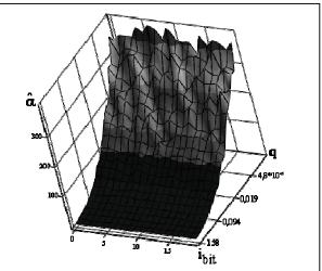
Рис. 4. Зависимости изменения оценки показателя модели от отношения сигнал/шум на входе приемника
