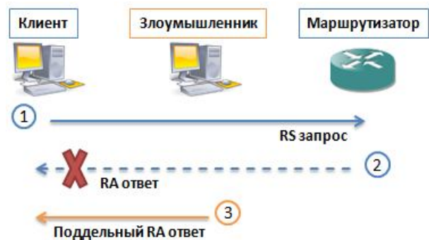
Рис. 3. Механизм атаки на процесс обнаружения маршрутизатора в IPv6
