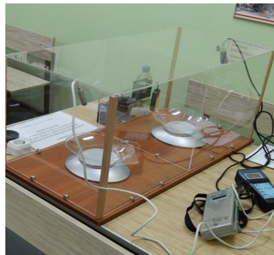
Рис. 1. Установка для дослідження залежності інтенсивності випаровування ЛЗР та ГР з відкритої поверхні від швидкості руху повітряних мас та температури навколишнього середовища
