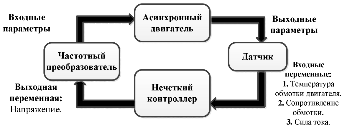
Рис. 1. Схема управления асинхронным двигателем с применением нечеткого контроллера
