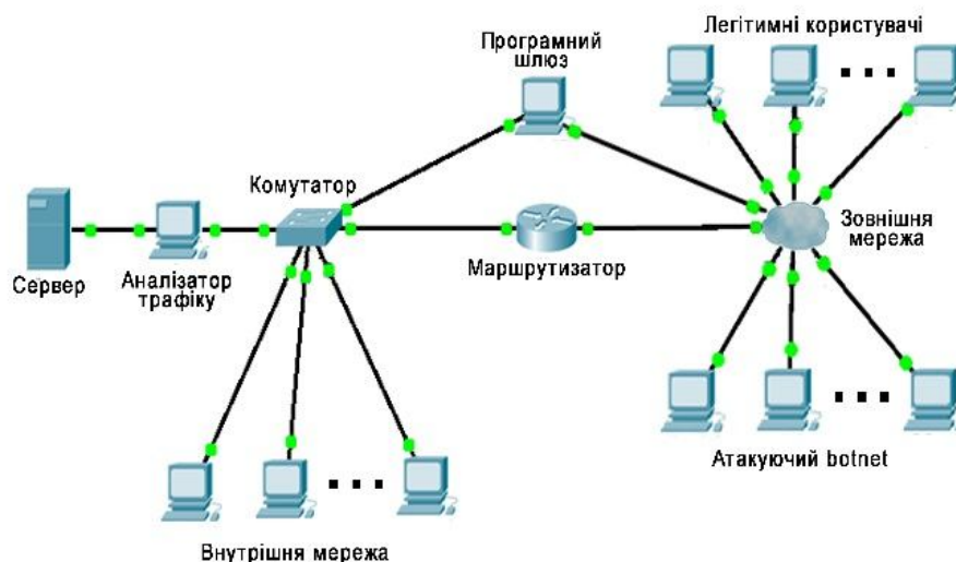
Рис. 1. Структура ІТКС, що забезпечує блокування повільної DoS-атаки
