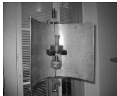
Рис. 3. Экспериментальная установка с излучателем СВЧ
