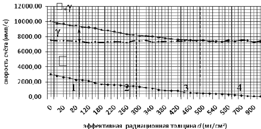
Рис. 5. Зависимость скорости счёта детектора от эффективной радиационной толщины алюминиевого фильтра (границы нагрузок: 1 – на кожу; 2 – на глаза; 3 – на гонады; 4 – на весь организм)
