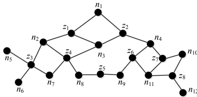
Рис. 5. Плоское кенигово представление возможной конфигурации WMN WiMAX
