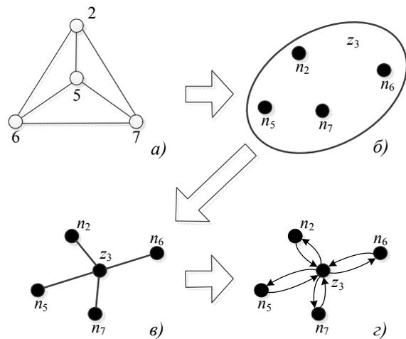
Рис. 4. Примеры представления возможной конфигурации домена коллизий WMN в виде графа (а) гиперграфа (б) плоского кенигового представления (в) и двудольного ориентированного графа (г)
