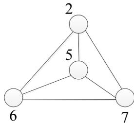
Рис. 1. Пример зоны устойчивого приема WMN WiMAX, формируемой множеством mesh-станций, имеющих связь «каждая с каждой»
