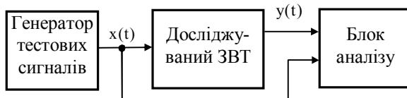
Рис. 3. Узагальнена схема для визначення динамічних характеристик МВТ
