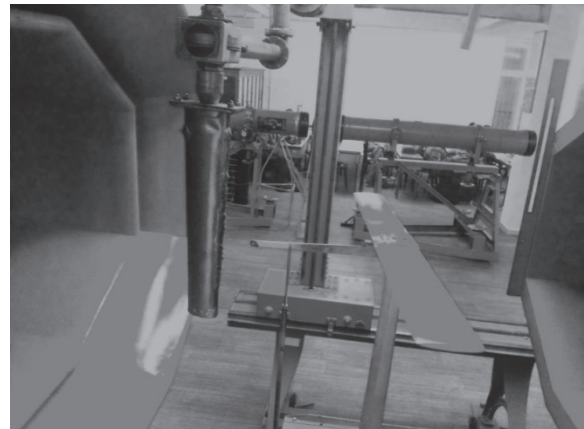
Рис. 2. Фотография интегрирующей гребенки и испытуемого прямого крыла в рабочей части аэродинамической трубы Т-1
