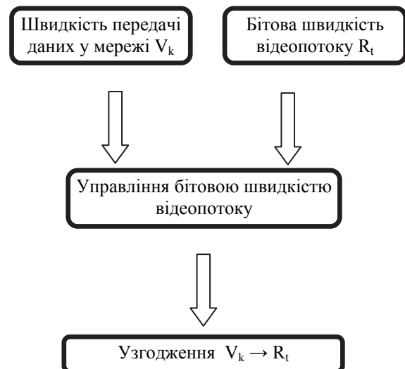
Рис. 4. Блок-схема узгодження біткової швидкості відеопотоку і швидкості передачі даних в мережі
