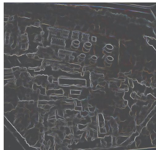
Рис. 3. Виділення границь структурованим детектором на зображенні з використанням машинного навчання Random Forest
