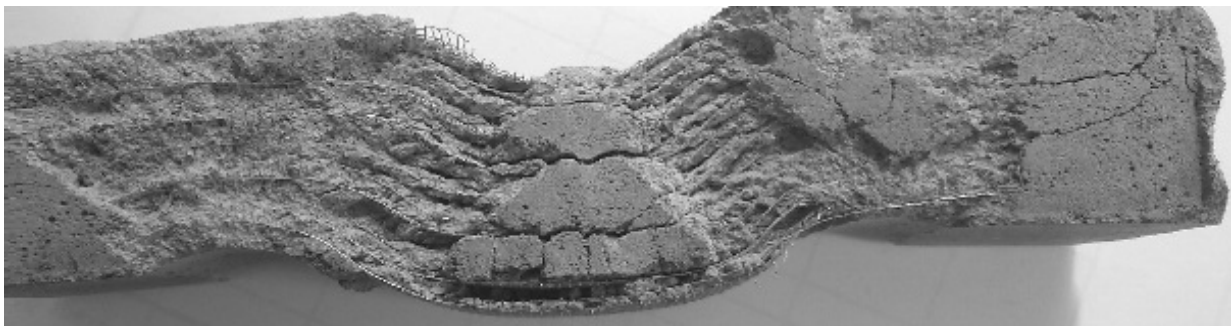
Рис. 5. Загальний вигляд зразка сталевібробетону після випробувань
