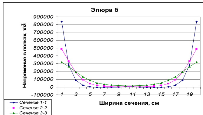
Рис. 2. Эпюра напряжений в сварном шве и в околошовной зоне полки ригеля для данной расчетной модели (рис. 1)
