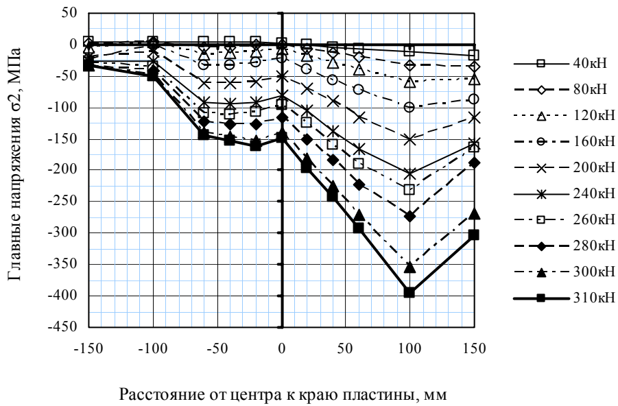
Рис. 6. Распределение главных напряжений \sigma_{1,2} ( \sigma_1 > \sigma_2 ) в пластине с температурой нагрева в центре 1000\text{ }^\circ\text{C}
