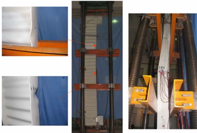
Рис. 5. Экспериментальные исследования стержней с поперечно-гофрированной стенкой синусоидального очертания, подверженных сжатию с изгибом
