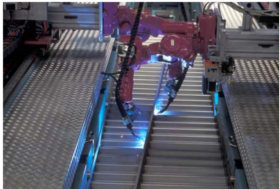
Рис. 4. Линия для изготовления двутавров с гофрированными стенками
