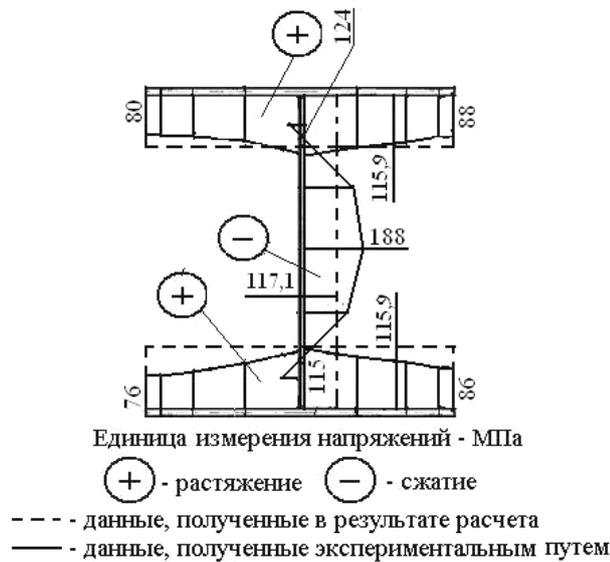
Рис. 4. Эпюры ОН для образца серии СНУ
