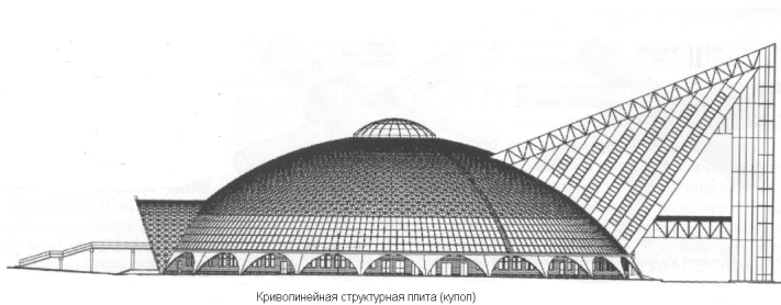
Рис. 2. Криволинейная структурная плита (купол)
