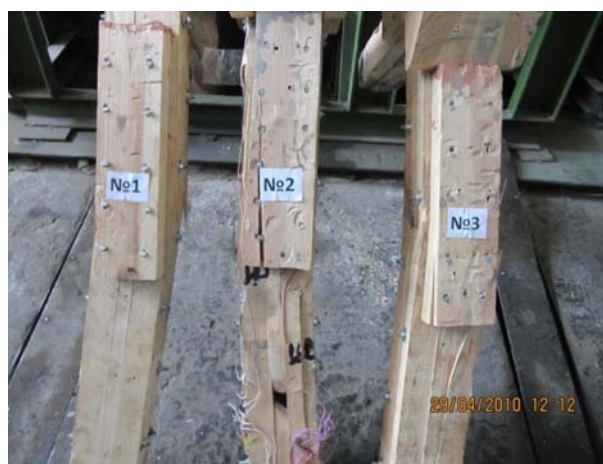
Рис. 4. Образцы после разрушения
