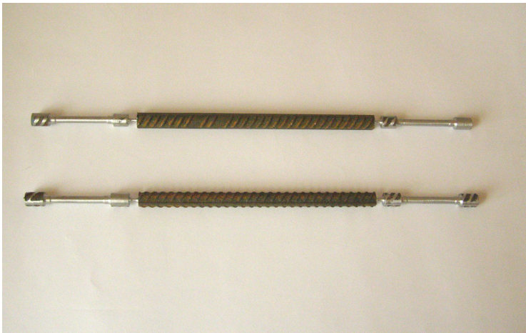
Рис. 1. Виготовлення експериментальних зразків з арматури періодичного профілю
