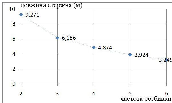
Рис. 7. Довжина найдовших елементів для різних варіантів частоти розбивання при діаметрі купола D = 30 м
