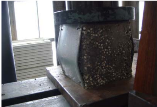
Рис. 5. Характер руйнування зразків із вільними ненавантаженими кромками
