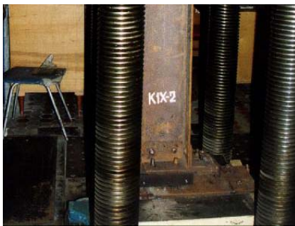
Рис. 1. Общий вид съемных опорных приспособлений, устанавливаемых на сварных образцах [7] в нижней части
