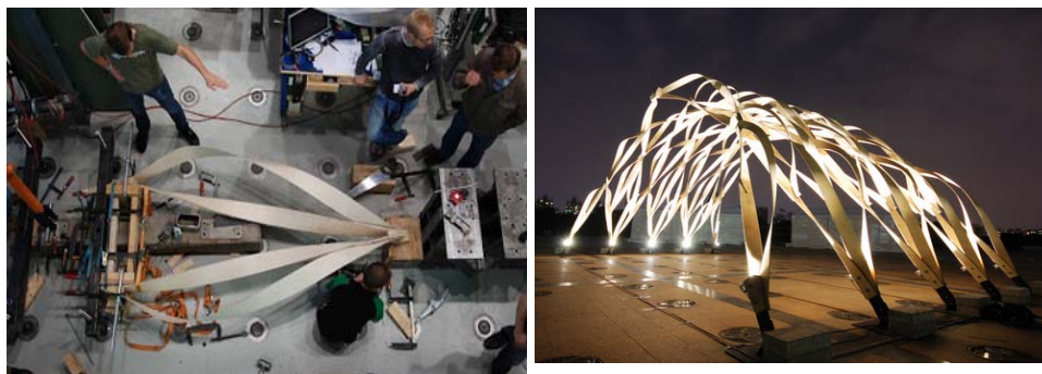
Рис. 1. Испытание элементов конструкции «Radical wood pavilion»
