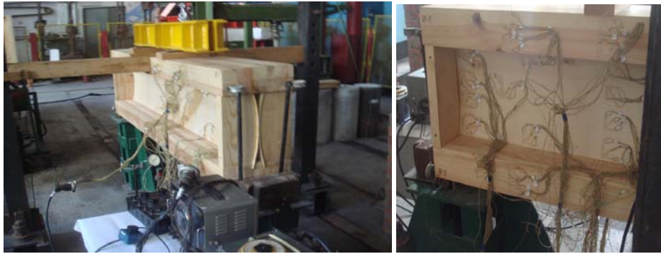
Рис. 4. Экспериментальный образец X-образной балки
