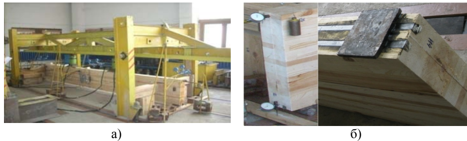
Рис. 1. Общий вид испытаний балок: а) общий вид испытаний, б) торец армированной балки
