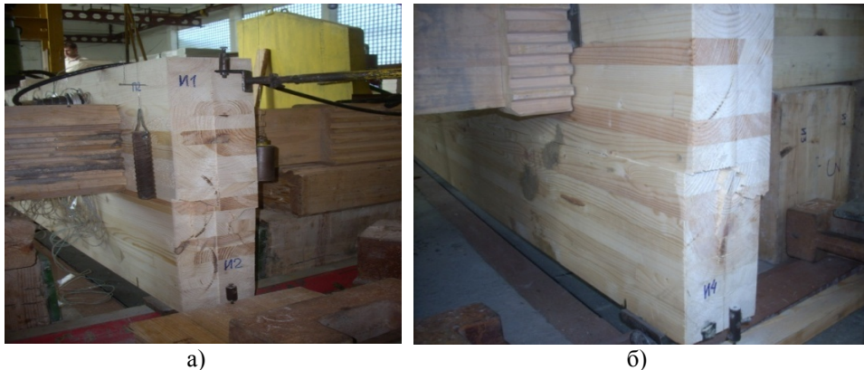
Рис. 7. Разрушение торцов балок Б-1 (а) и Б-2 (б)
